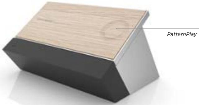
PatternPlay funktioniert nur, wenn die Holzseite der Schnittstelle (Jukebox) nach oben zeigt. Aktivieren Sie PatternPlay, indem Sie die Mitte des Holzrings berühren oder die BeoRemote One verwenden. Rufen Sie „PatternPlay“ auf der Fernbedienung auf und drücken Sie die mittlere Taste. Weitere Informationen finden Sie unter den FAQs auf [www.bang-olufsen.com/faq](http://www.bang-olufsen.com/faq).
